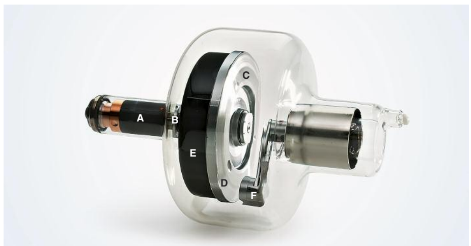
图30 X射线管靶材的转子 (A)、杆 (B) 和带有钨钼合金轨道 (D) 的钼合金靶 (C)，用于产生X射线。图中还显示了石墨散热器 (E) 和包含钨丝的阴极杯 (F) © Plansee SE (X射线管由Dunlee生产)
