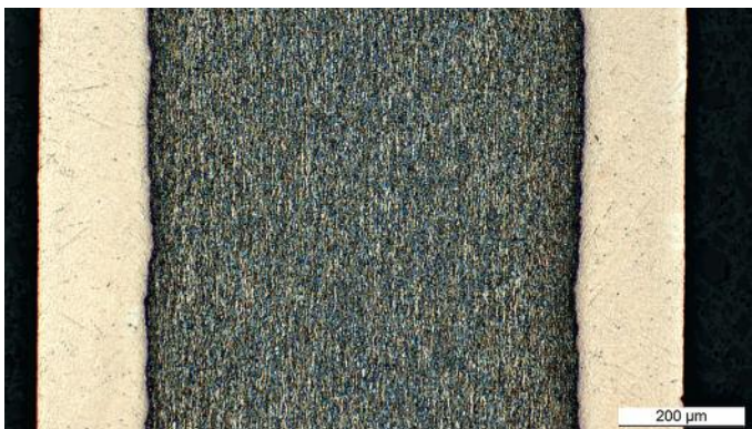
图22 一种“复合-复合”材料结构显示了MoCu核心和铜表面层 © Plansee SE
