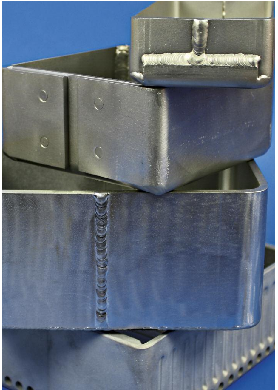
图59 钼舟展示了基本的成形和加工技术以及 GTA 焊接将连接处的缝隙密封 © Elmet Technologies
