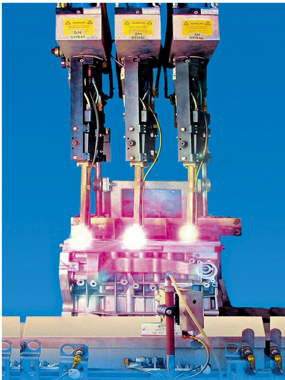
图49 用于汽车气缸喷涂的成组自动旋转喷枪技术。虽然这不是钼喷涂的应用，但它说明了当前技术可能达到的复杂程度 © Sulzer Metco
