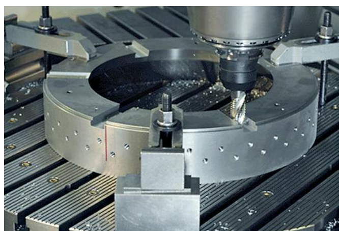
加工一个已历经不同加工工艺的部件 © Plansee SE
