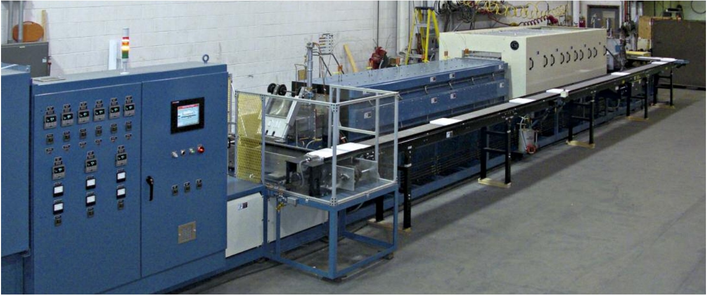
图45 采用钼加热元件的高温氢气气氛炉 © CM Furnaces
